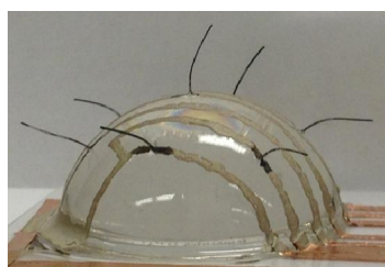
垂直放置的电子胡须用于周围气流 3D 绘图
